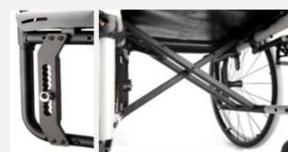
Per altezze seduta da terra pari a 470 o inferiori non è possibile montare ruote da 7"
